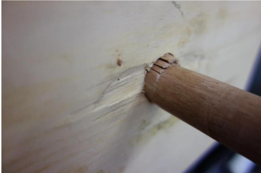
Abb. 10: Versagen durch Abscheren des Dübels
