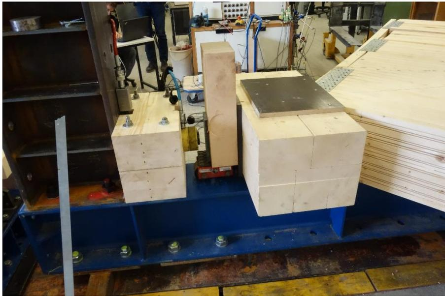
Abb. 15: Für die Schubprüfungen verwendete Belastungseinrichtung
